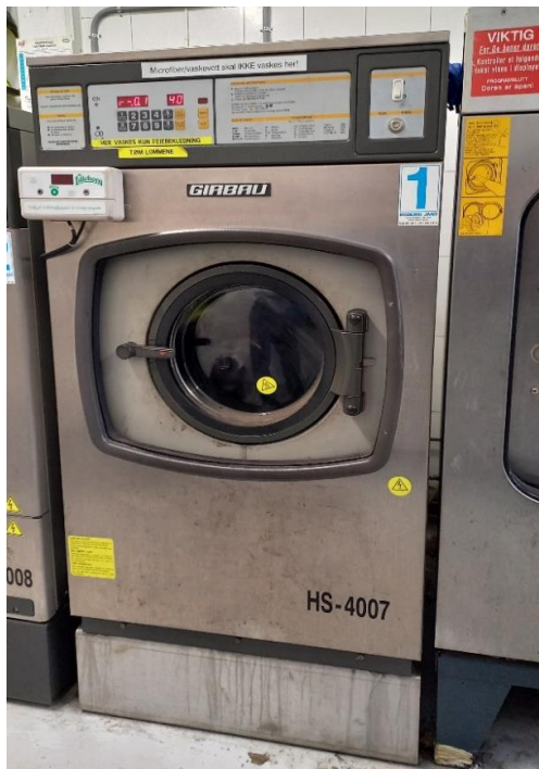
Bild 1. Tvättmaskin från Girbau som användes vid tvätförsöken av skyddskläder för sotare.
