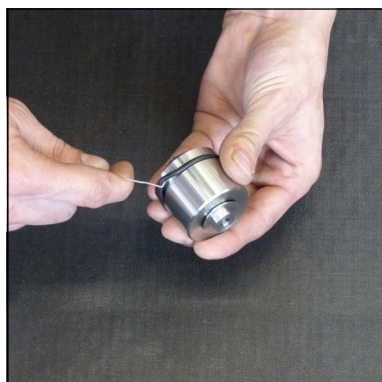
Abb. 3 - O-Ring wechseln (Kondensat-Stopp-Ventil)
